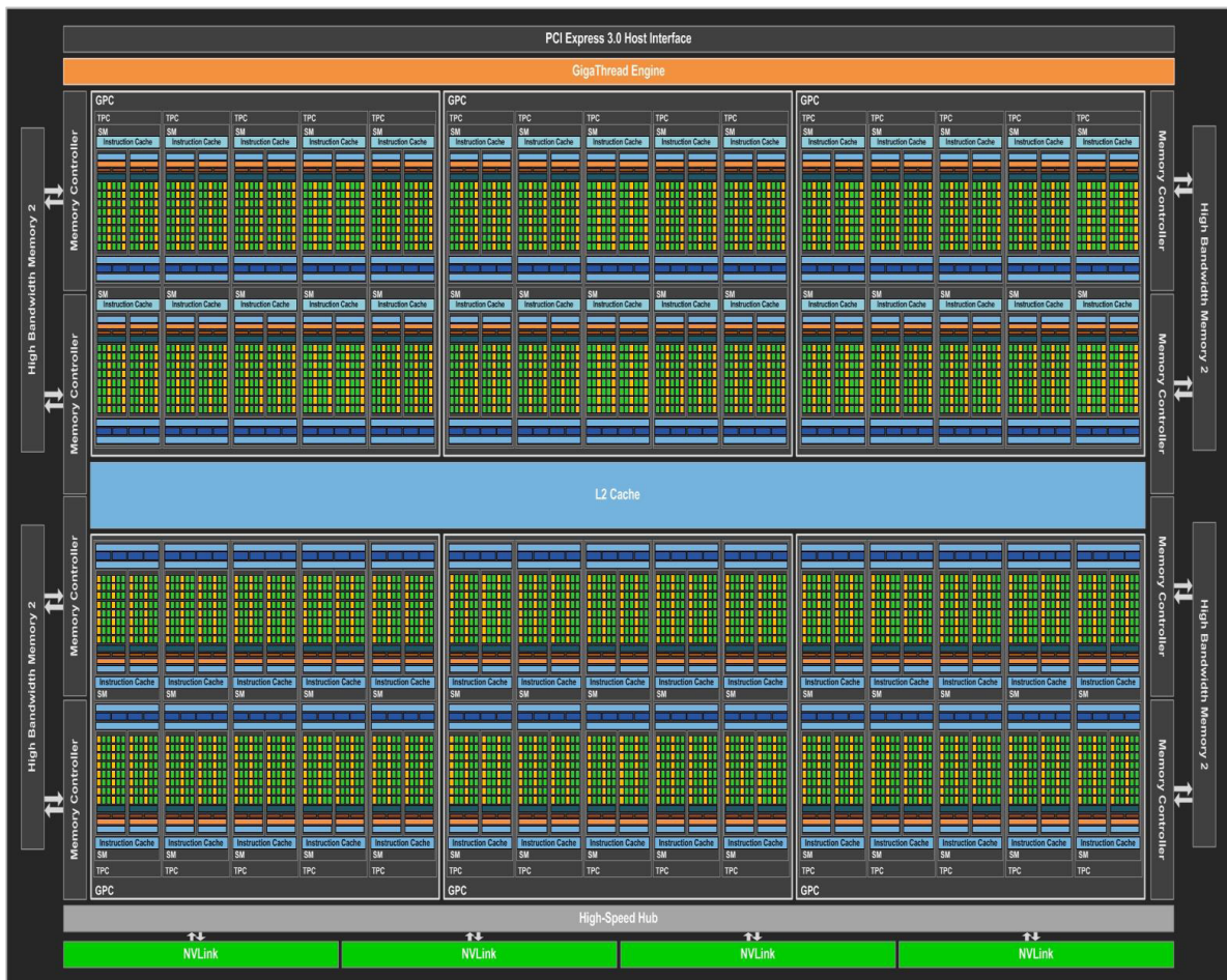
Abbildung 1: GP100 Architektur im Vollausbau mit allen 60 möglichen Streaming Multiprocessoren [6]
